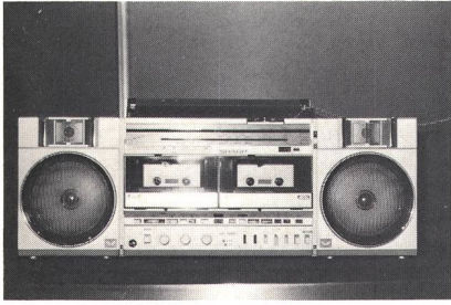
Fig. 1 Stereo-Kassetten-Kofferradio mit Zweikassettenslaufwerk zum Überspielen oder pausenlosen Kassettenbetrieb
