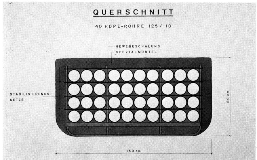
Fig. 3 Kunststoffrohrblock-Querschnitt in der Limmat
