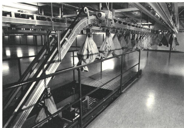
Fig. 7 Sackstapler mit Abstieg – Rail de stockage des sacs et descente vers le niveau inférieur
