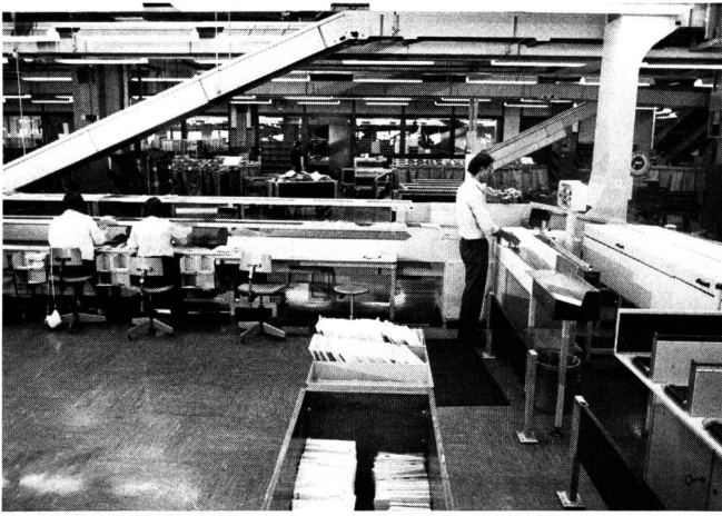
Fig. 10 Teilmechanische Briefaufbereitungsanlage. In der Bildmitte ist die Förderbandanlage mit den manuellen Arbeitsplätzen für das Formattrennen zu sehen. Rechts davon die Stoffeingabevorrichtung zur automatischen Aufstell- und Stempelmaschine
