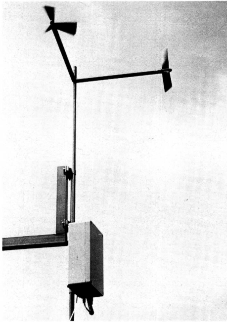
◀ Fig. 1 2-Komponenten-Windmesser auf einem Meteomast montiert. Die Propellerarme sind nach Norden und Osten ge- richtet.
