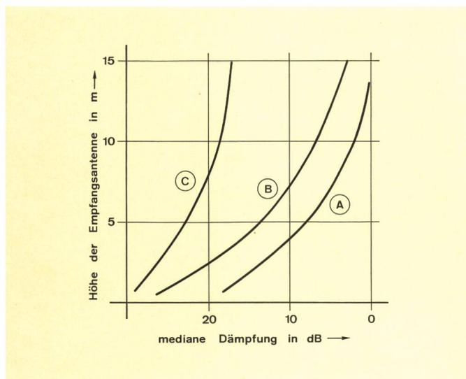
Fig. 1 Dämpfung durch nahe Empfängerumgebung (100 MHz)
