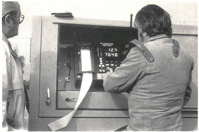
Fig. 13 Die effektiv am Kabelende auftretende Zugkraft wird gemessen und über Leiter, die im Zugseil eingebaut sind, zur Zugeinrichtung übertragen
