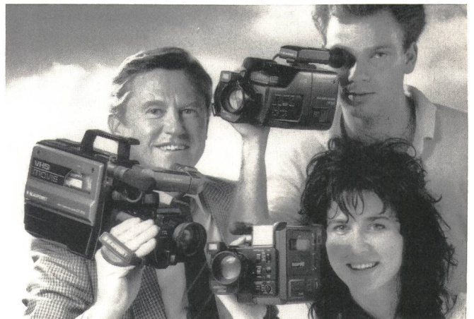
Fig. 6 Die drei heute auf dem Markt befindlichen Camcordersysteme auf einem Bild zeigen die Ähnlichkeiten in Grösse und Ausstattung. V.l.n.r.: Kamera mit der normalgrossen, mit der kleinen VHS-C-Kassette (die in jedem VHS-Gerät mit einem Adapter abspielbar ist) und mit 8-mm-Kassette (Foto Blaupunkt)
