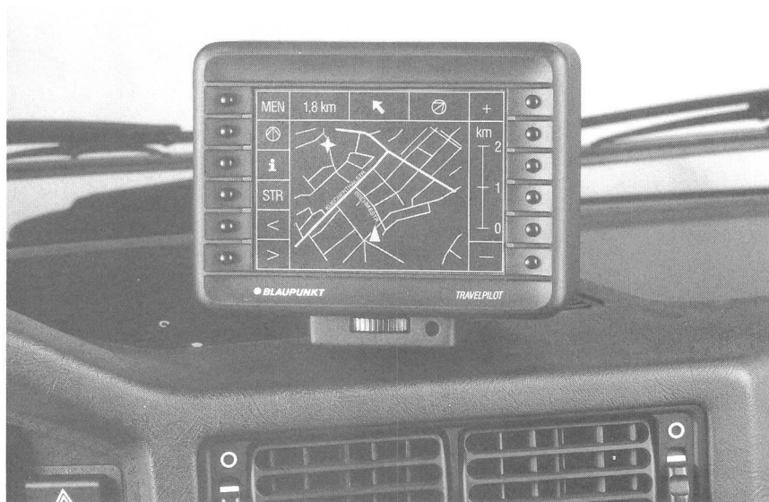
Fig. 1 Sicht- und Bedienungsgerät des Travel-Piloten. In der Mitte der Kartenausschnitt mit gegenwärtigem Standort des Fahrzeuges (▲) und dem Fahrziel (+), den Streckenabschnitten, Abzweigungen und Kreuzungen. Rechts davon die sechs Tasten für die Zieleingabe mit Buchstaben, oben Anzeigen über Entfernung bis zum Ziel und Abzweiganzeigen, rechts Massstab
