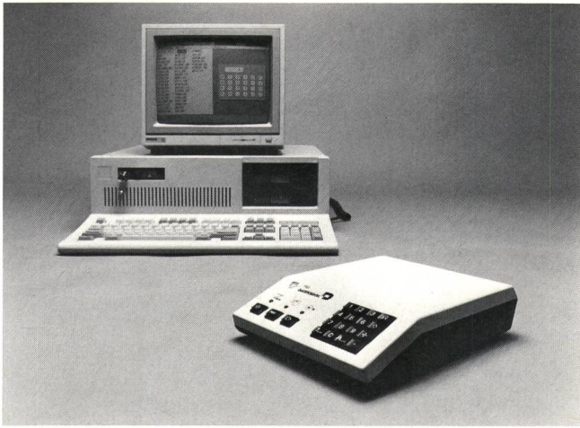
Fig. 1 Telexanschlussgerät mit PC – Appareil de raccordement télex avec PC
