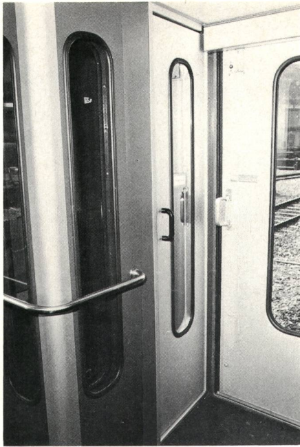
Fig. 8 Schallisolierte Kabine für das Telefon im Zug – Cabine insonorisée du téléphone dans les trains
