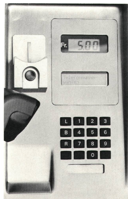
Fig. 6 Display der Benutzerführung und Tastatur der Kassierstation – Affichage du guidage de l'utilisateur et clavier du poste à prépaiement
