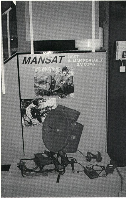
Fig. 11 Neben Satellitenantennen für kleine Business-Bodenstationen war am Stand von Ferranti Electronics auch diese nur 16 kg schwere, portable «ManSat»-Ausrüstung für 50-bit/s-Satellitenverbindungen mit einer 46-cm-Antenne für militärischen Einsatz zu sehen
