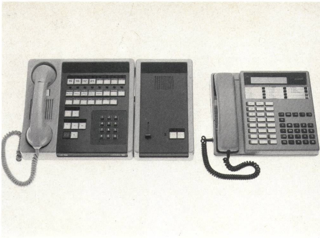
Fig. 3 Confronto fra la grandezza di un LWA 8/15 con altoparlante supplementare e di un LW 700 Comercio: i due apparecchi offrono le stesse prestazioni
