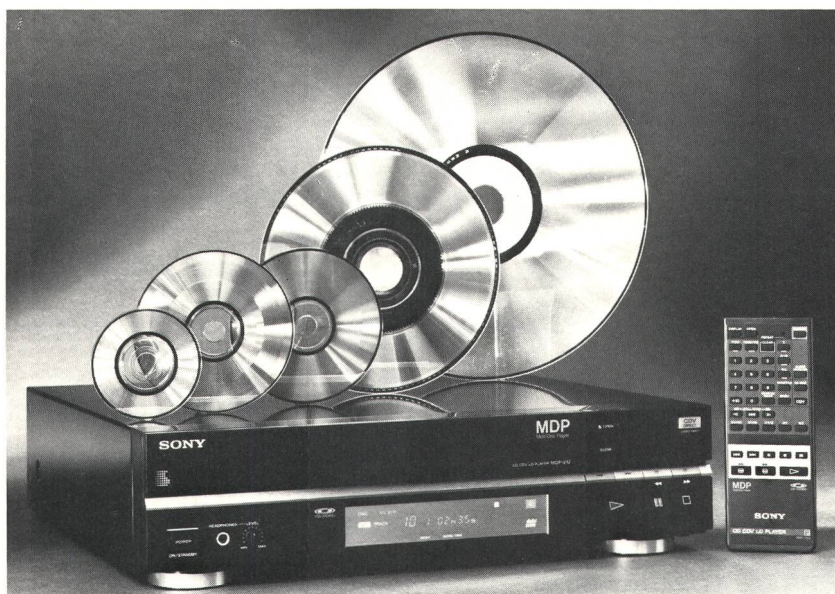
Fig. 9 Multi-Disc-Player für Audio- und Video-CDs mit Fernbedienung. Ganz links die neue 8-cm-CD-single neben der bekannten 12-cm-CD, rechts die drei goldenen Video-CDs
