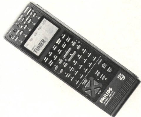
Fig. 8 Lernfähige Fernbedienungs-Handcomputer, u. a. von Philips, lassen sich auf beliebige Systemkomponenten einer Audio/Videoanlage (Verstärker, Tuner, Platten- und CD-Spieler, Tuner, Tape-Deck, Audio- und Videorecorder sowie Teletext) programmieren. Sie machen die bisherigen Fernsteuerungen für jedes Einzelgerät überflüssig
