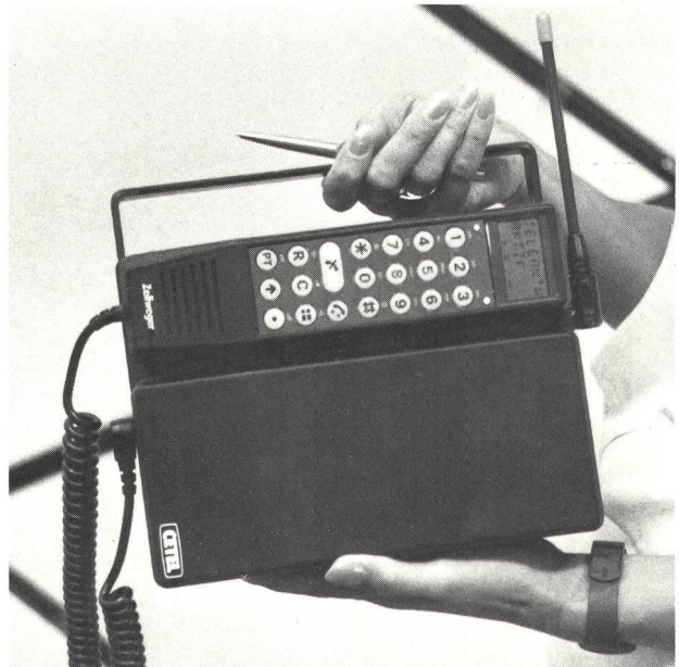
► Fig. 4 Natel-C-Telefon mit eingebautem Anrufbeantworter der Firma Zellweger, die mit ihrem Preisangebot an der Fera einen Preissturz auslöste
