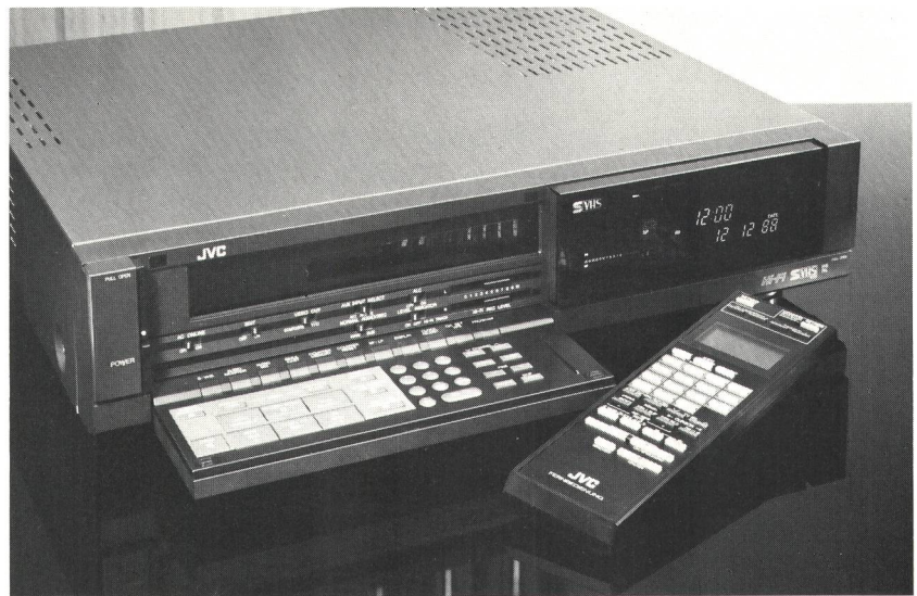
▲ Fig. 16 Hinter der Klappe dieses Super-VHS-Recorders versteckt sich ein ganzes Regiepult, das neben dem Steuern und Programmieren des Recorders noch eine Reihe weiterer Möglichkeiten, wie Standbild, Zeitlupe, Suchlauf usw., bietet
