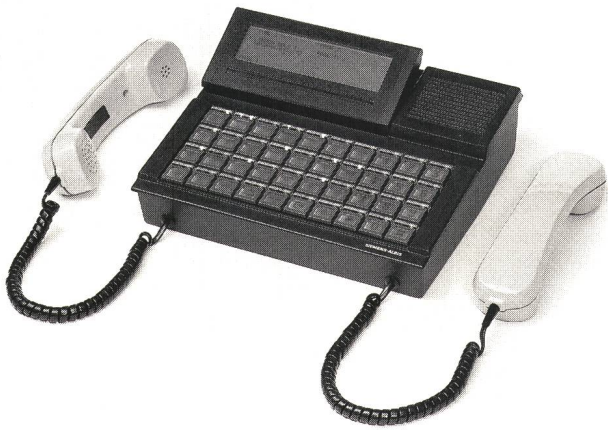
Fig. 5 Dealer Key Board zu ECS-C L'appareil de desserte pour courtiers (DKB) de l'ECS-C (Bild/Photo: Siemens-Albis AG)
