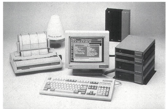
Fig. 7 Equipement INMARSAT C - Impianto INMARSAT C
