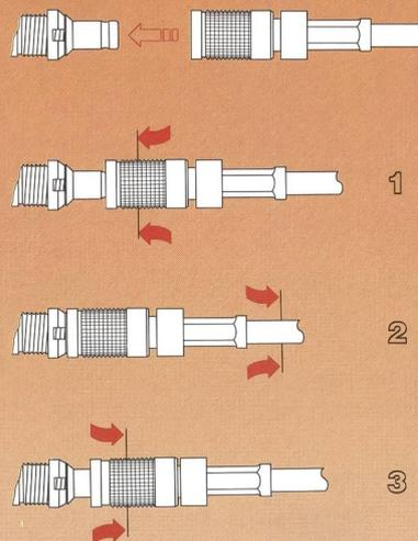
**1.** Le verrouillage de la fiche dans l'embase s'obtient par une simple poussée axiale sur le corps extérieur de la fiche.
