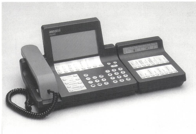
Fig. 10 Optionsmodul OMC 16 Am Ascotel Crystal ansteckbar
