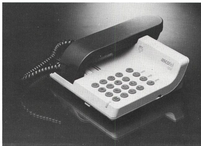
Fig. 9 Das neue ISDN-Basisendgerät Ascotel Opal Als Linienwähler- wie als Komfortapparat verwendbar
