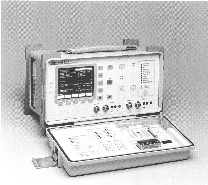
Erlaubt Bitfehlerraten test (BER-Test) an Kommunikationssystemen mit Datenraten bis zu 8 MBit/s, während oder ausserhalb des Betriebes.
