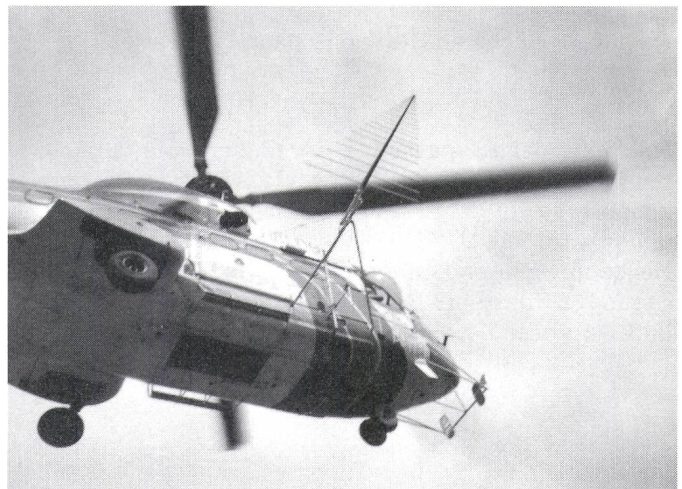
Fig. 9 Messantenne am Helikopter
