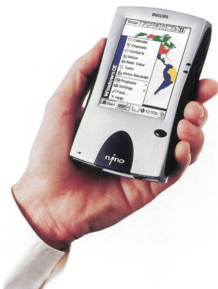
Bild 3. «Window CE Palme-size PC line» Nino 500 von Philips mit 16 Mbit Memory.
