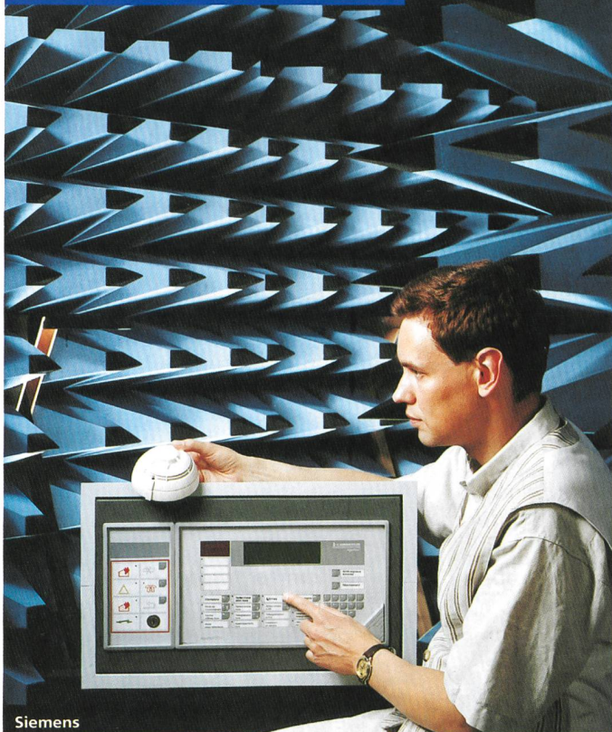
Ein Sicherheitssystem muss einwandfrei funktionieren und wird gründlich getestet; hier in Bezug auf die elektromagnetische Verträglichkeit.
