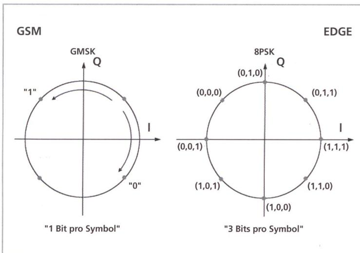
Bild 1. Modulation GSM und EDGE im IQ-Diagramm.
