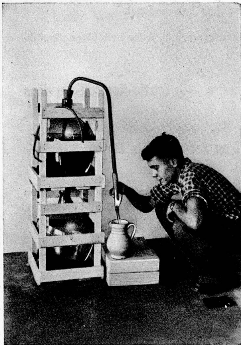
Ausschank mit Siphon (Leistung 12 Liter pro Minute)
