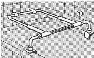
① **Bade-Helfer**, wird am Wannenrand oder an der Wand montiert. Sichere Stütze beim Einsteigen oder Verlassen der Badewanne aus eigener Kraft.
