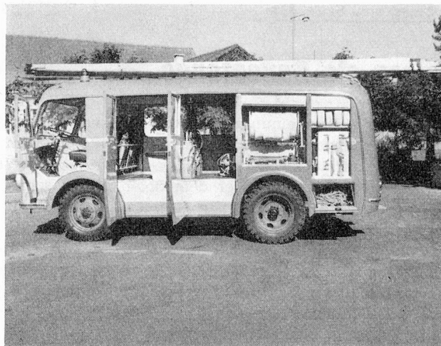
Pikettwagen mit Kleinlöschgeräten, Handfeuerlöschern, Schlauchmaterial, Pressluft- und Gasschutzgeräten, Leitern usw.
