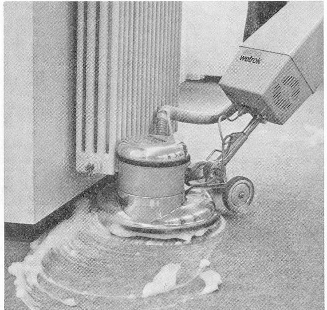
Mit der Servo-Wetrok-Einbürsten-Bodenreinigungsmaschine mit 43 cm  $\phi$ , ausgerüstet mit dem Shampomat Schaumaggregat, kann 100 %ig randnah und auch unter Radiatoren und Möbeln einwandfrei gereinigt werden. Lästige Handarbeit entfällt.
