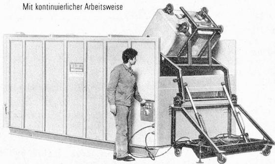
Für grossen Kehrichtanfall. Rationelle Abfuhr durch Absetz- oder Gleitabsetzkipper. Riesige Einfüllöffnung. Bequeme Beschickung von Hand oder mit 240- und 800-l-Container. Minimale Installation - nur Steckeranschluss.
