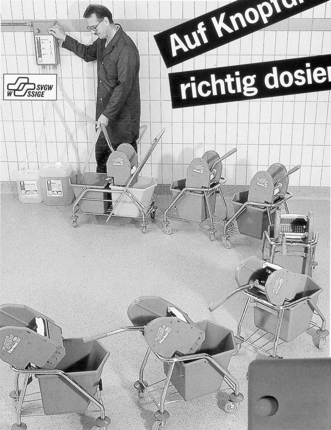
**Topmater J 10** heisst das neue, hydraulisch betriebene Injektordosiergerät für die automatische Herstellung gebrauchsfertiger Lösungen von Reinigungs- und Abwaschmitteln sowie Desinfektionsreinigern.
