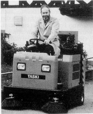
Der TASKI balimat 140 T zeichnet sich – nebst den beeindruckenden Leistungszahlen – auch durch die optimale Sitzposition des Fahrers und den minimalen Wendekreis von 194 cm aus. Bei einer Maschine von 168 cm Länge bedeutet dies: Wenden an Ort!
