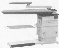
Tischblatthöhe verstellbar von 74–92 cm, rostfreies Tischblatt (XL 125 x 50 x 23 cm), thermostategelgte Tischblatt-Temperatur, einfaches Umstellen von Blasen auf Saugen mit Fusspedalleiste, Absaugsperr des Tischblattes beim Arbeiten mit dem Ärmelbügler, Abstellfläche für Dampfbügeleisen, Auffangtuch für Bügelgut, zwei Rollen hinten am Tisch montiert – für einfache Verschiebung
