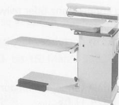
Tischblatthöhe verstellbar von 80–95 cm, rostfreies Tischblatt (XL 125 x 50 x 23 cm), thermostatgeregelte Tischblatt-Temperatur, Dampfabsaug-Ventilator auf breiter Fussleiste steuerbar, Absaugsperr des Tischblattes beim Arbeiten mit dem Ärmelbügler, Abstellfläche für Dampfbügeleisen, Auffangtuch für Bügelgut
