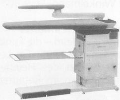
Tischblatthöhe verstellbar von 74–92 cm, rostfreies Tischblatt (XL 125 x 50 x 23 cm), thermostatierte Tischblatt-Temperatur, einfaches Umstellen von Blasen auf Saugen mit Fusspedalleiste, Absaugsperr des Tischblattes beim Arbeiten mit dem Ärmelbügler, Abstellfläche für Dampfbugeleisen, Auffangtuch für Bügelgut, zwei Rollen hinten am Tisch montiert – für einfache Verschiebung
