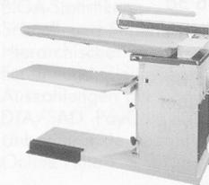
Tischblatthöhe verstellbar von 80–95 cm, rostfreies Tischblatt (XL 125 x 50 x 23 cm), thermostatierte Tischblatt-Temperatur, Dampfabsaug-Ventilator auf breiter Fussleiste steuerbar, Absaugsperr des Tischblattes beim Arbeiten mit dem Ärmelbügler, Abstellfläche für Dampfbugeleisen, Auffangtuch für Bügelgut
