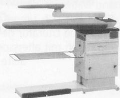
Tischblatthöhe verstellbar von 74–92 cm, rostfreies Tischblatt (XL 125 x 50 x 23 cm), thermostatregelte Tischblatt-Temperatur, einfaches Umstellen von Blasen auf Saugen mit Fusspedalleiste, Absaugsperr des Tischblattes beim Arbeiten mit dem Ärmelbügler, Abstellfläche für Dampfbügeleisen, Auffangtuch für Bügelgut, zwei Rollen hinten am Tisch montiert – für einfache Verschiebung
