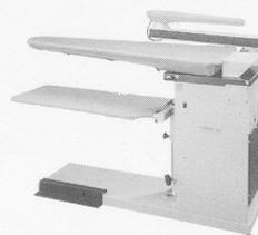
Tischblatthöhe verstellbar von 80–95 cm, rostfreies Tischblatt (XL 125 x 50 x 23 cm), thermostatregelte Tischblatt-Temperatur, Dampfabsaug-Ventilator auf breiter Fussleiste steuerbar, Absaugsperr des Tischblattes beim Arbeiten mit dem Ärmelbügler, Abstellfläche für Dampf bügeleisen, Auffangtuch für Bügelgut
