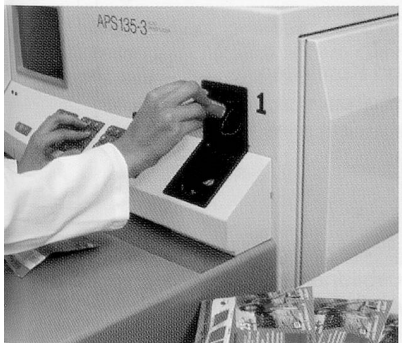
Die Filme werden für die Weiterverarbeitung zusammengespleist.
