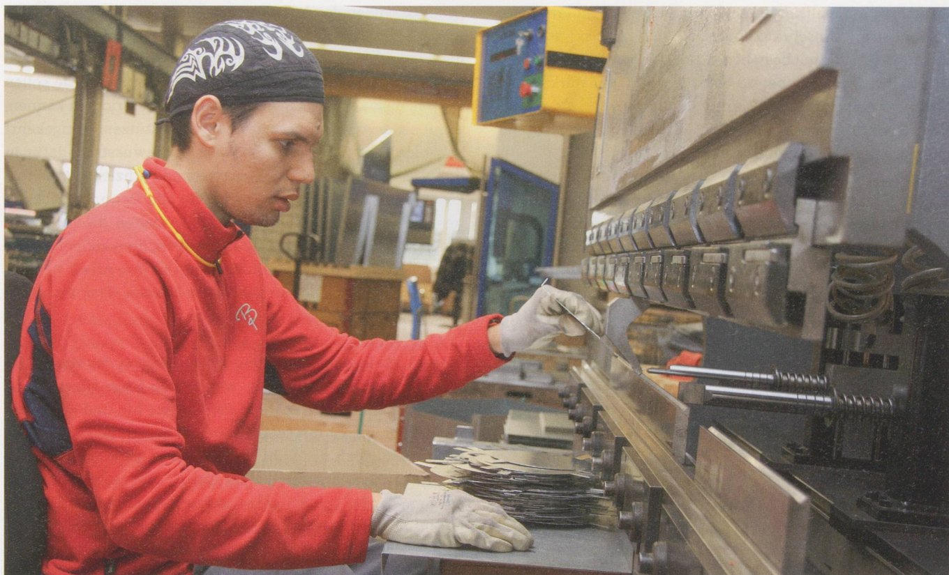
An der Abkantpresse biegt Vincent Borys Blechteile, Bestandteile der Lüftungsgeräte, die die Firma Cosmatech herstellt. Letzten Sommer schloss er die zweijährige Ausbildung zum Industriepraktiker ab.
