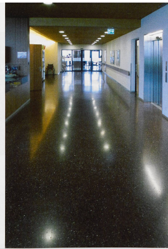
ergeben spiegelnde, blendende und rutschige Oberflächen (r.). Schwarze Streifen an den Stufenvorderkanten bieten Orientierung. Kaum und Möblierung geben Abwechslung, das Tageslicht fällt von oben ein: vorbildliche Demenzstation (l.).
