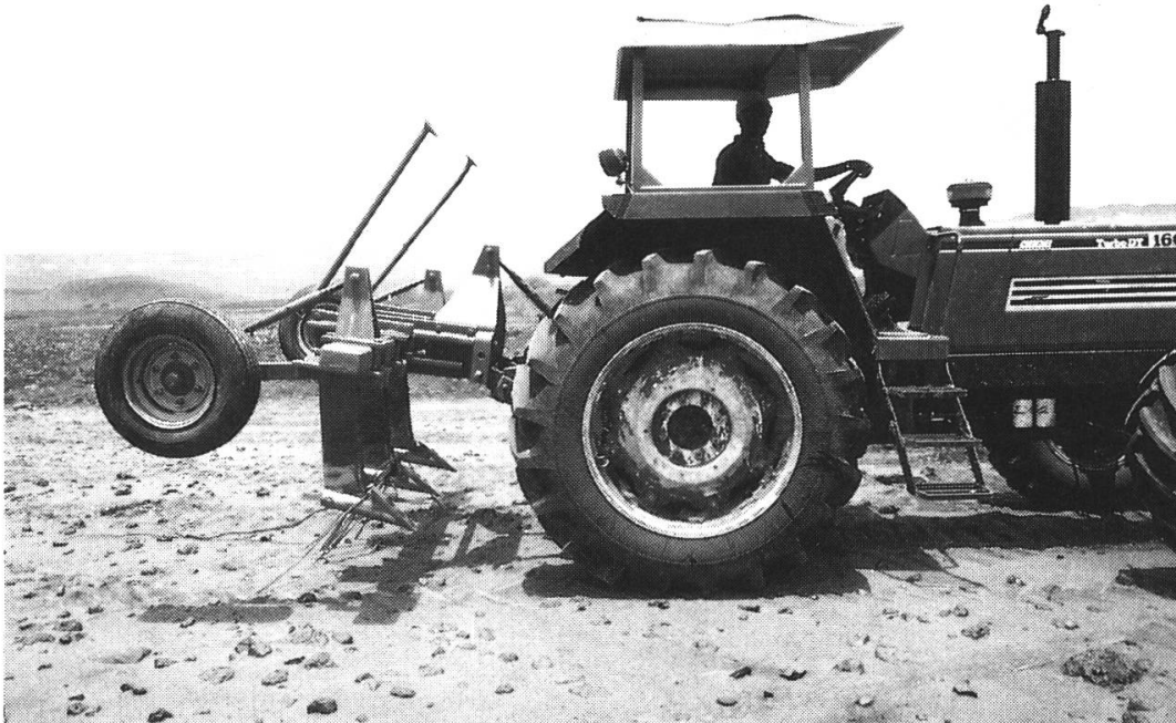
Fig. 4. — Intervention «lourde». Sous-solage mécanisé dans le but de briser la croûte et de restaurer la fertilité par un labour profond (Projet Keita). Ce type de mesure, cher, n'est pas possible sans faire appel à un investissement extérieur important.
