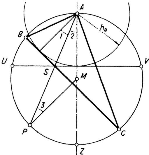
**Lösung:** Schlage um  $A$  den Kreis mit dem Radius  $h_a$  und ziehe an diesen die Tangente  $UV$ , die senkrecht zum Durchmesser  $AZ$  steht. Ziehe die Sehne  $AP$  durch den Schnittpunkt  $S$  von  $BC$  und  $UV$ . Nun ist
