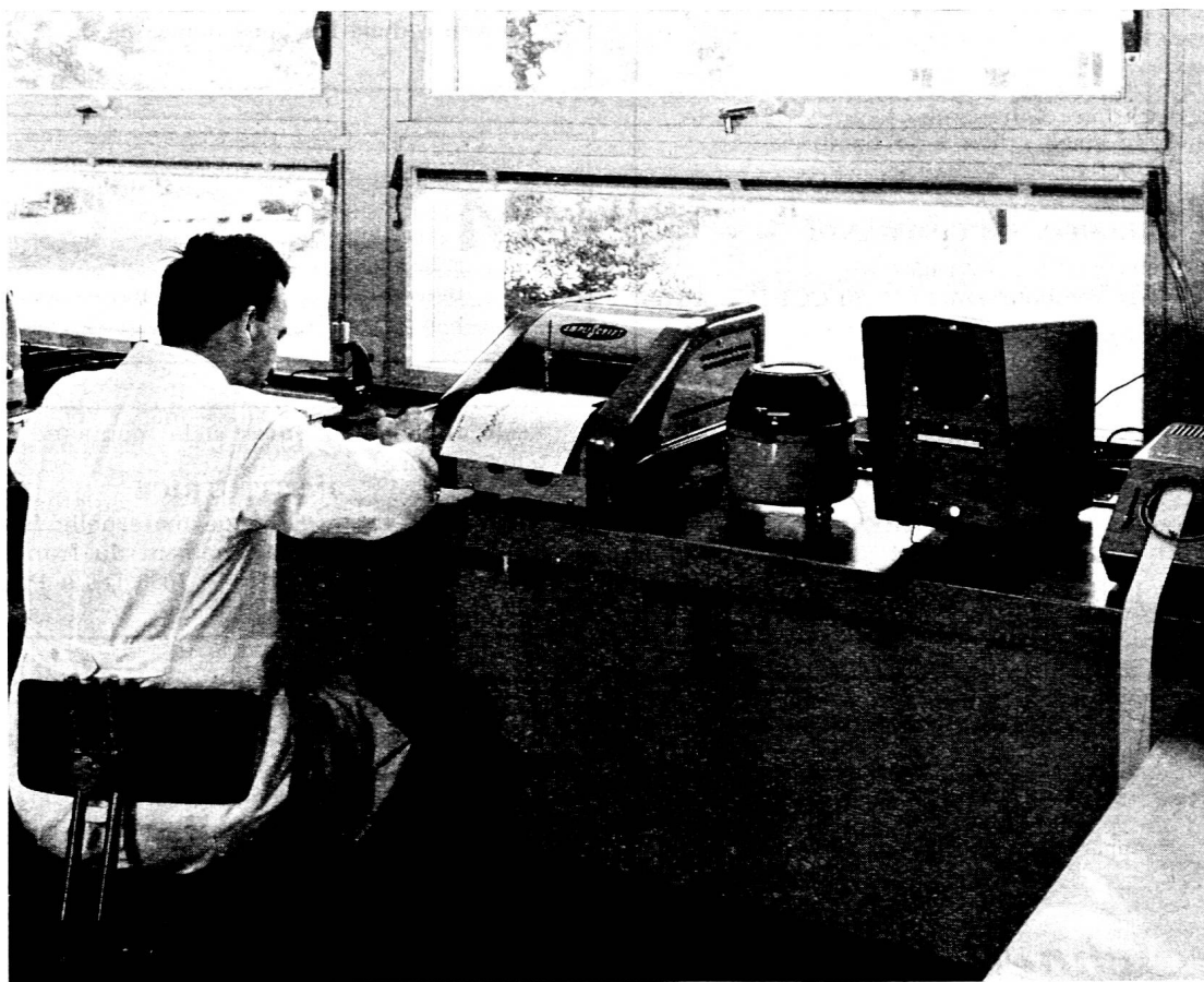
Des instruments de plus en plus modernes viennent faciliter le travail de l'horloger. Ici, des appareils à contrôler la marche instantanée des montres.
