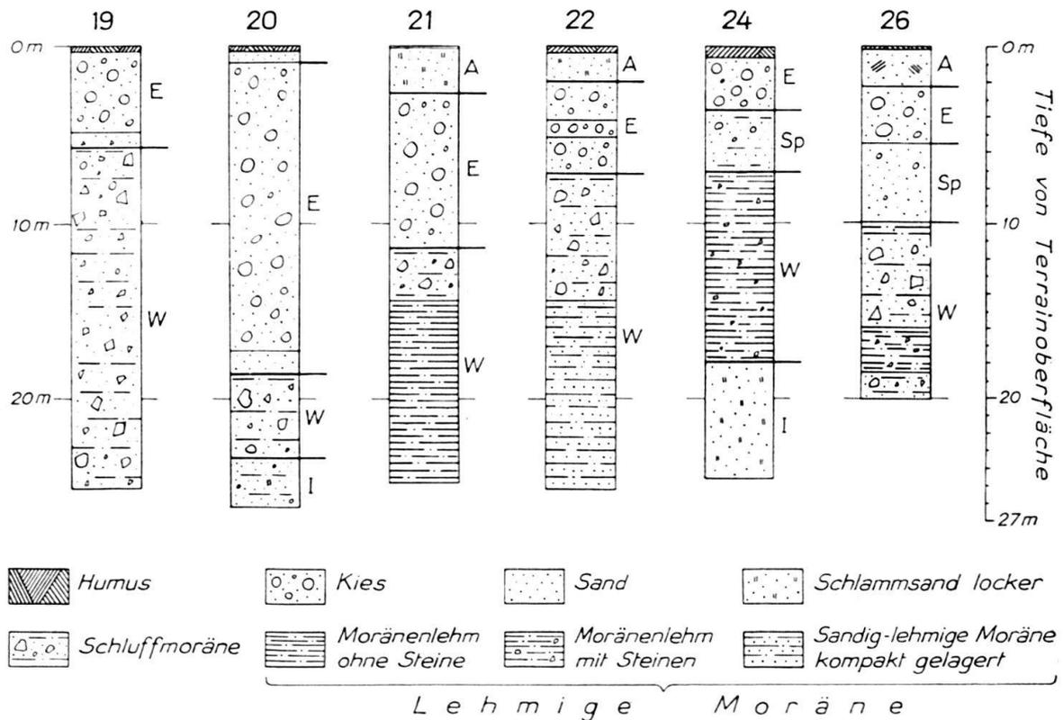
Fig. 2. Bohrprofile aus dem Raume Bernerschachen-Hohfuhren, vereinfachte Fassung.
