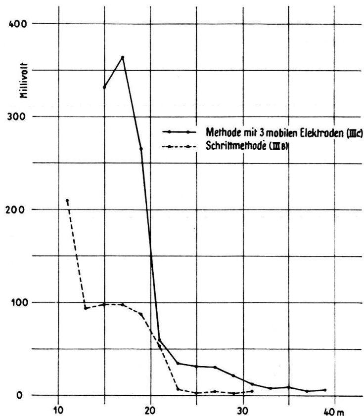
Fig. 18. Beispiel des Verlaufs der Potentialdifferenz, gemessen nach der kombinierten Methode (siehe Fig. 20, Profil U).
