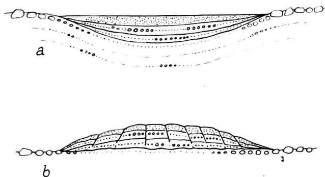
Fig. 1. Inversion du relief. *a* Formation par les torrents épiglaciaires de sédiments dans une dépression du glacier (fluvio-glaciaire); *b* fluvio-glaciaire déposé reposant sur les restes d'une moraine superficielle.
