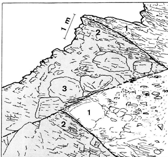
Fig. 7. Die Lagerungsverhältnisse des Dioritgangs vom Piz Val Gronda. 1 Nebengestein; verschieferte Zweiglimmer-Albit-Gneise. 2 Verschiefter, diaphthorierter Diorit. Stoffgrenze zum Nebengestein diskordant zur Schieferung, Schieferung des Diorits konkordant zur Schieferung des Nebengesteins. 3 Massiger, relativ gut erhaltener Diorit, in einzelnen Blöcken. Zusätzlich ist der Gang an einer Bruchfläche versetzt.
