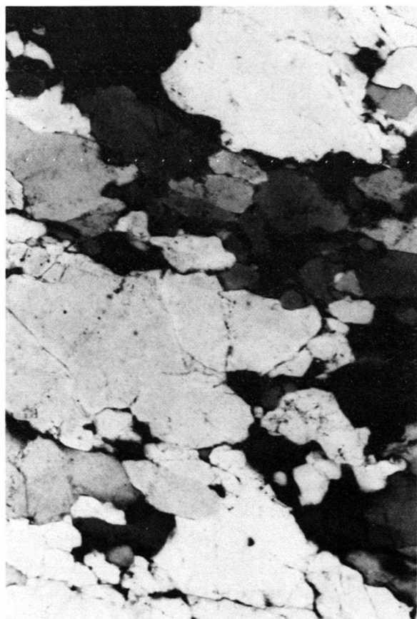
Fig. 8. Quartzite orienté. - Galet des grès sidérolithiques du Ravin des Avenières (D-33). Lumière polarisée. Grossissement \times 50 .
