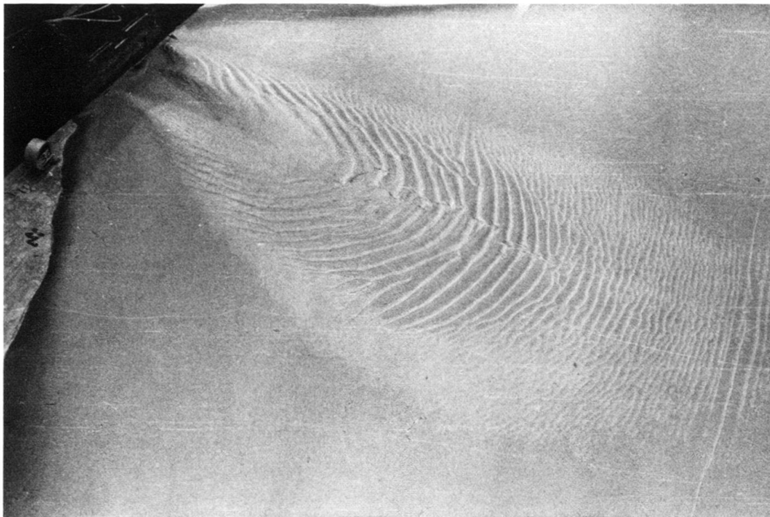
Fig. 9. Ablagerungsbild eines Silt-Trübestroms. Erkennbar sind die etwas asymmetrische Rinne, anschliessend der Rippelkranz sowie die seitliche Begrenzung der Ablagerung.
