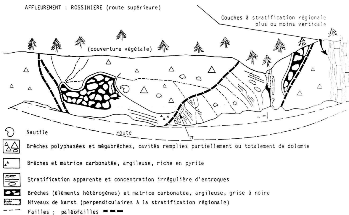
Fig. 7. Rossinière: dessin de l'affleurement avec les faciès particuliers de brèches et mégabrèches avec dyke neptunien ( \pi sur le dessin) rempli de quartz imprégné de goethite, avec figure de slumps.
