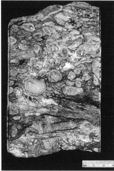
Fig. 4. Event-Bed: (Sehr) gut gerundete Sandsteinklasten in einer Matrix aus tonflaserigem Sandstein. Einige der Klasten sind randlich verfärbt (Oxidationssäume?). Trotz der Verwühlung lässt sich eine leichte Gradierung erkennen. Horizont Her D 1 , Bohrung Herdern-1, 1712,35 m. Gesägte Probe.
